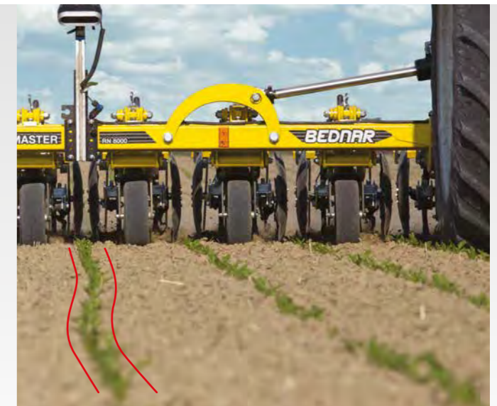
System samonaprowadzania jest zdolny do prowadzenia pielnika Row-Master, nawet jeśli uprawa jest wysiana po łuku.
