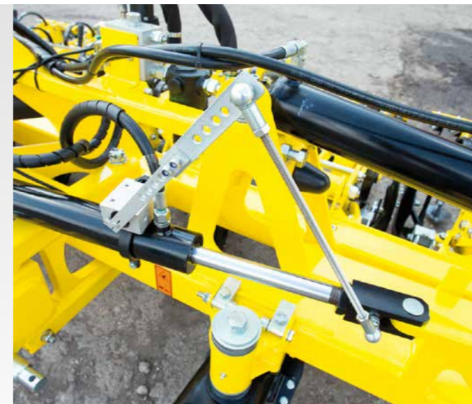
Czujniki aktualnego położenia ramy maszyny są w relacji z 3-punktowym układem zawieszenia.
