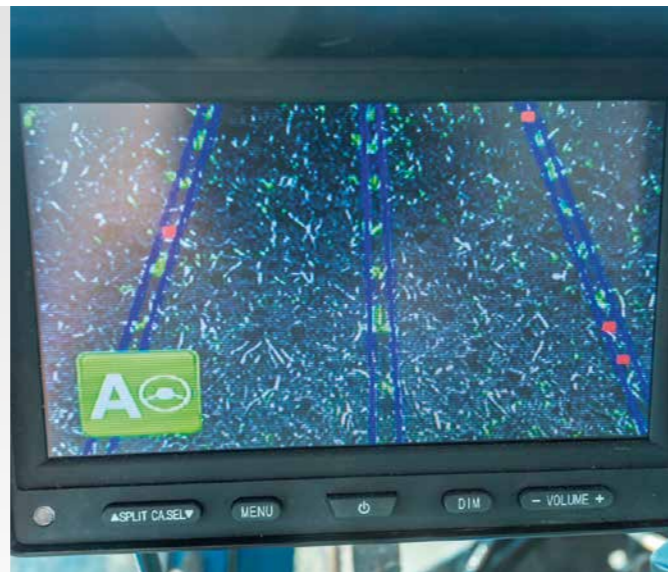
System monitorujący CultiCam zawiera 7 calowy wyświetlacz, który przesyła informacje o uprawie do operatora.
